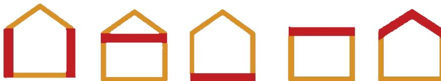
Tous les isolants ne conviennent pas à toutes les applications. Selon qu'on désire isoler la toiture, les murs ou le sol ; qu'on envisage de la faire par l'intérieur, par l'extérieur ou dans la structure ; le choix des matériaux et de leur conformation (vrac, panneaux souple, panneaux rigides) sera différent.
